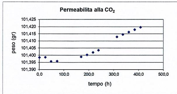
Considerando la resistenza del supporto ( $S_{dCO_2}$  supporto = 3,571 m), si ricava, per il campione in esame, il seguente valore medio di resistenza al trasporto:
