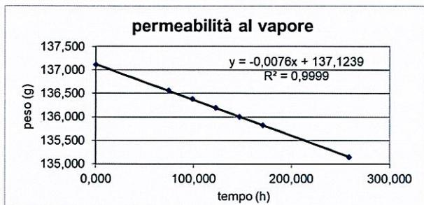
Considerando la resistenza del supporto ( $S_d = 0.0563$  m), si ricava, per il campione in esame, il seguente valore medio di resistenza al trasporto:
